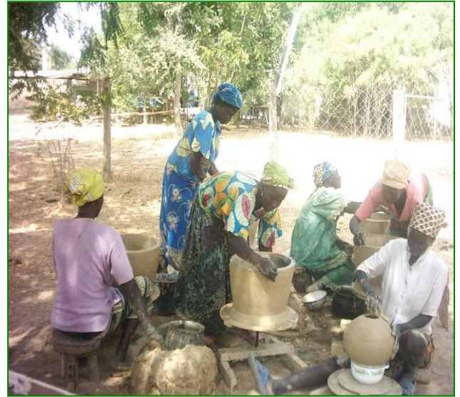
Photo 7 : Construction des foyers céramiques par les groupes de femmes de Guidiguis
