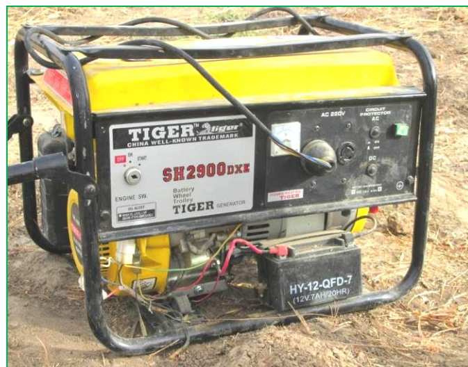
Groupe électrogène pour le forage
